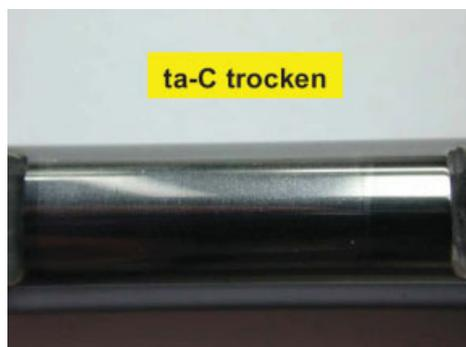
**Abb. 4: Oberfläche der ta-C-beschichteten Ziehkante nach mehreren Streifenziehversuchen von AlMg5Mn (trocken).**
