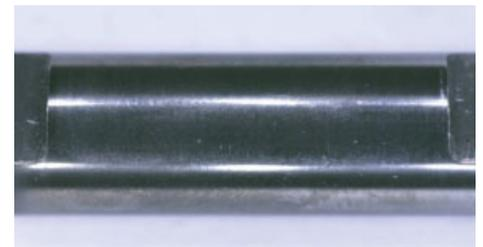
**Abb. 6: Oberfläche des ta-C-beschichteten Werkzeuges nach 820 Streifenziehversuchen von Al99,9Mg1-Blechen (trocken).**
